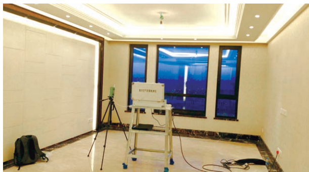
▲ 室内空气检测
